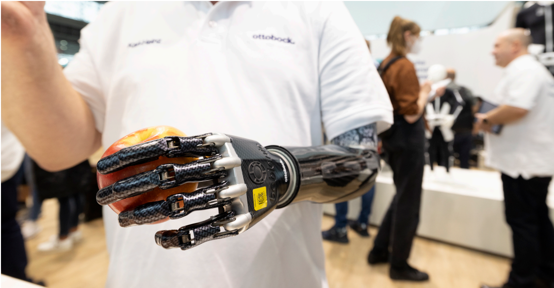
Bebionic Handprothese von Ottobock mit 14 wählbaren Griffarten und Handpositionen.
